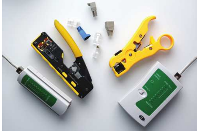
Görsel 4.12: Telefon kablosunun test malzemeleri
