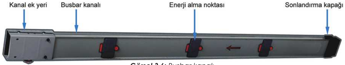
Görsel 3.6: Busbar kanalı
