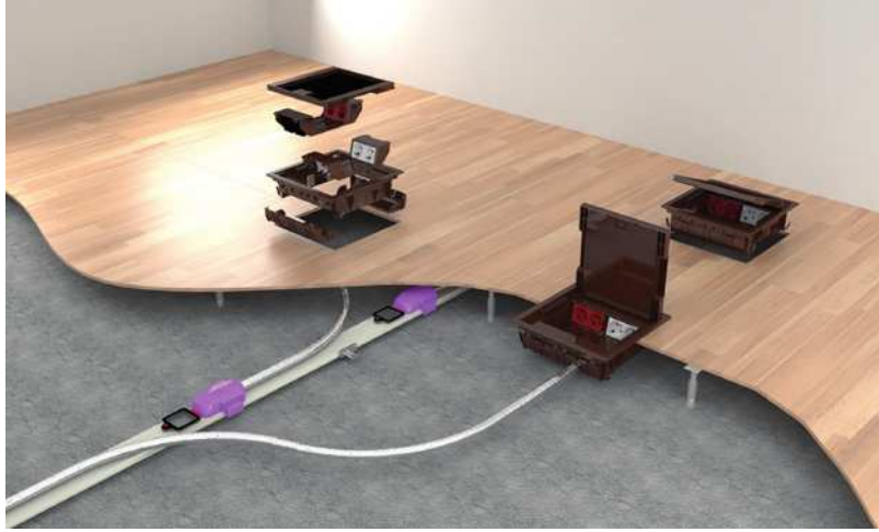
Görsel 2.25: Yükseltilmiş döşeme altı tesisatları
