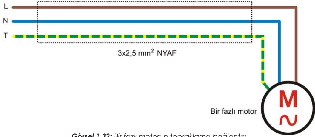
Görsel 1.32: Bir fazlı motorun topraklama bağlantısı
