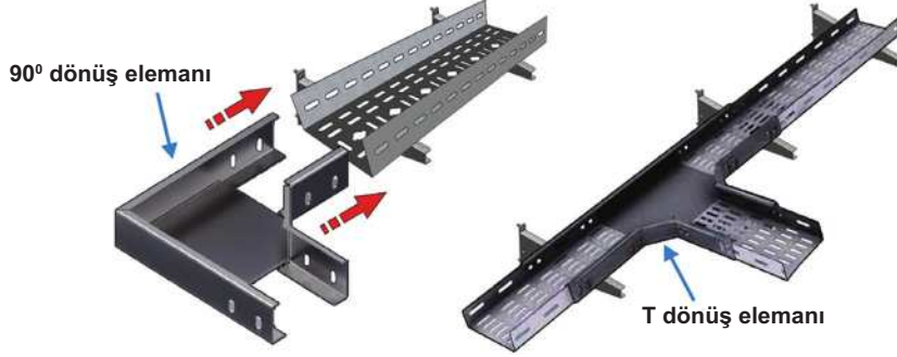
Görsel 2.17: Metal kablo kanalı dönüş aksesuarlarının montajı
