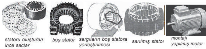
Resim 1.2: Statorun yapısı
