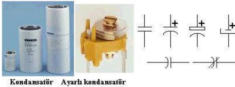
Resim 2.1: Değişik kondansatörler ve sembolleri
